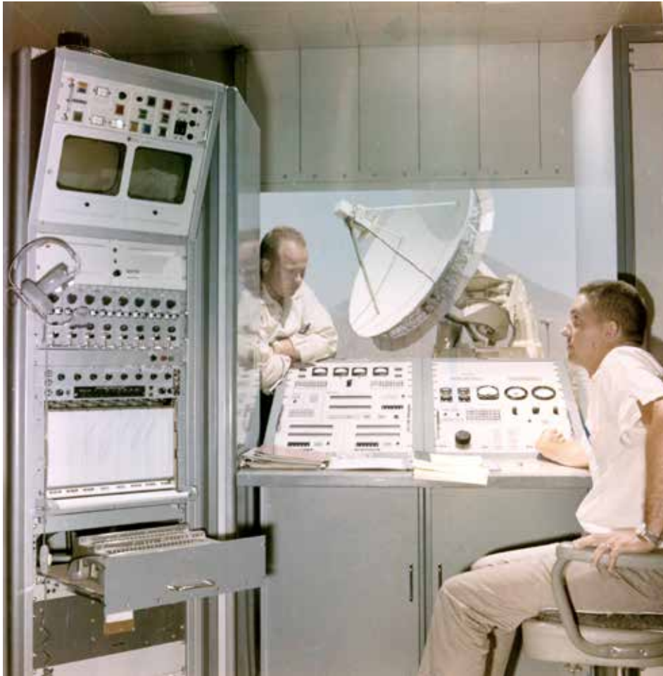
FIG 7 Equipos radio receptores y control de antenas (en primer plano) y antena de 12 m de diámetro (al fondo) en la estación de monitoreo de satélites NASA-Chile, hoy Swedish Space Corporation (SSC), Peldehue, Chile. Hacia la década de 1960. / Radio receivers and antenna control equipment (foreground) and 12 m diameter antenna (background) at NASA-Chile satellite tracking station, current Swedish Space Corporation (SSC), Peldehue, Chile. Towards 1960's. Fuente / Source: Swedish Space Corporation.
